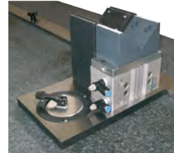
Prüfvorrichtung mit Hartsteinbasis zur Kontrolle der Geradheit von Druckmaschinenwellen, schonende Vorzentrierung in Kunststoffprismen. Das Heben und Senken des Werkstücks in die Messposition erfolgt pneumatisch.
