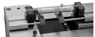
Voreinstellen von Innenmessschrauben Pre-setting of internal micrometers
