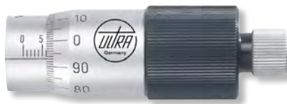
Ableseung 0,01mm, Spindelsteigung 1,0mm (100 Teilstriche auf der Trommel, Ableseung ohne Addition)
