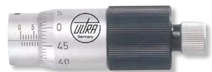
Ableseung 0,005mm, Spindelsteigung 0,5mm (100 Teilstriche auf der Trommel)
