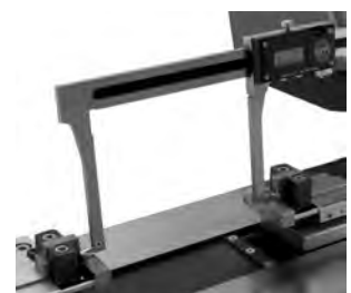
Voreinstellen von Universalmessschiebern Pre-setting of universal calipers
