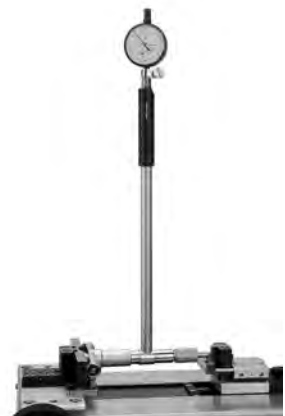
Voreinstellen von Innenfeinmessgeräten Pre-setting of bore gauge
