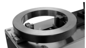
Messung von Innendurchmessern Measurement of inside diameters
